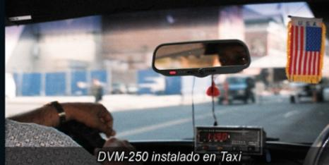
El sistema completo de video ha sido integrado dentro de un espejo retrovisor para minimizar uso de espacio y evitar interferencia con el campo de visión del chofer. Simplemente quite el espejo original de fábrica para instalarse dentro de cualquier modelo de vehículo.
