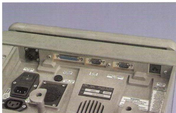
El panel posterior incluye tres (dos visibles) puertos RS-232, puerto de impresora y MODEM interno.
