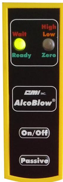
El AlcoBlow® tiene solamente dos botones para el operador y dos luces indicadoras, una de estas señala el estado del instrumento, la otra indica si se ha detectado alcohol.
